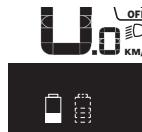
Worden bij een eBike met twee geplaatste accu's beide accu's op de fiets geladen, dan wordt op het display de laadvoortgang van de beide accu's weergegeven (op de afbeelding wordt net de linker accu geladen). Welke van de beide accu's niet geladen wordt, kunt u ook zien aan de knipperende aanduiding op de accu.
