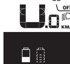
Hvis man på en eBike med to indsatte akku'er oplader begge akku'er på cyklen, vises opladningsstatus for begge akku'er på displayet (på billedet oplades den venstre akku). Hvilkend af de to akku'er der er ved at blive opladet, kan du også se på den blinkende indikator på akkuen.
