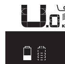
Lors de la recharge des deux batteries d'un vélo à deux batteries, l'écran indique l'état d'avancement de la charge des deux batteries (sur la figure ci-contre, la batterie de gauche est en train d'être chargée). La batterie en train d'être chargée est aussi reconnaissable au fait qu'elle clignote.
