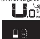
Se numa eBike com duas baterias colocadas forem carregadas ambas as baterias na bicicleta, então no mostrador é exibido o progresso de carregamento de ambas as baterias (na imagem está a ser carregada de momento a bateria esquerda). Qual das baterias está a ser carregada também é reconhecível na indicação a piscar na bateria.
